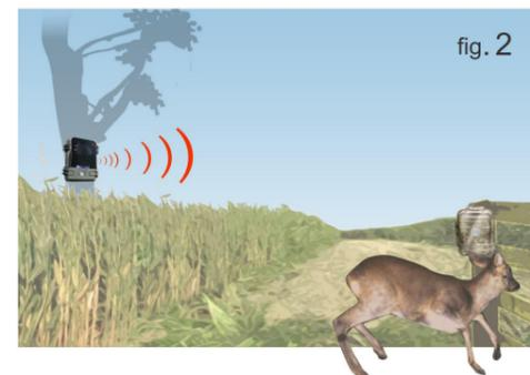
**Attivazione ed accensione:** quando il soggetto passa davanti ad uno dei sensori (o interno o remoto fig.1) il dissuasore si accende ed emette segnali sonori, e luminosi (versione con lampeggiatore) scoraggiandone l'ulteriore avvicinamento (fig. 2)
