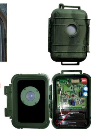
**PIR: la distanza di rilevamento del sensore può variare dai 10 ai 25 mt in relazione alla sensibilità impostata**
