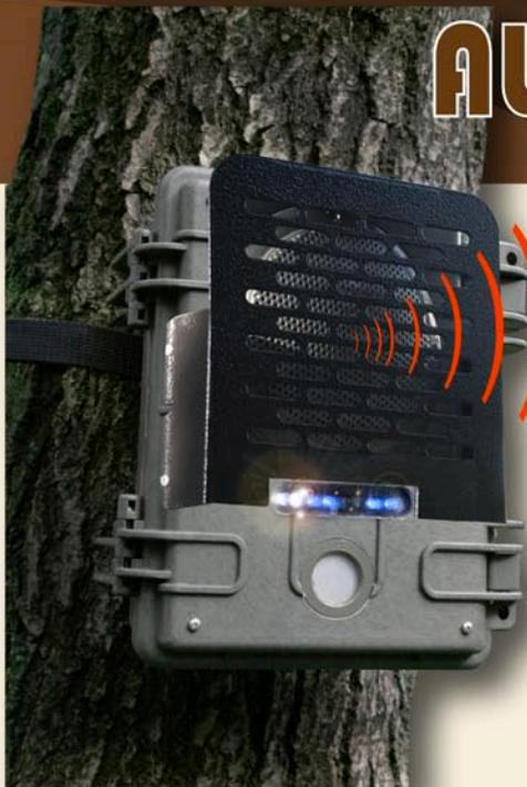
**Nuovo sistema automatico di dissuasione acustica-luminosa in MP3.** ALARM GUARD permette di rilevare l'avvicinamento di animali e persone in zone in cui il loro accesso è indesiderato, in assenza di operatore umano ed in ogni condizione meteorologica, allo scopo di dissuaderli dall'accedere con l'emissione a volume adeguato di rumori, suoni, voci, atti a creare allarme per gli stessi animali. **I LED LUMINOSI**, inseriti in questa nuova versione, ne aumentano l'effetto dissuasivo.
